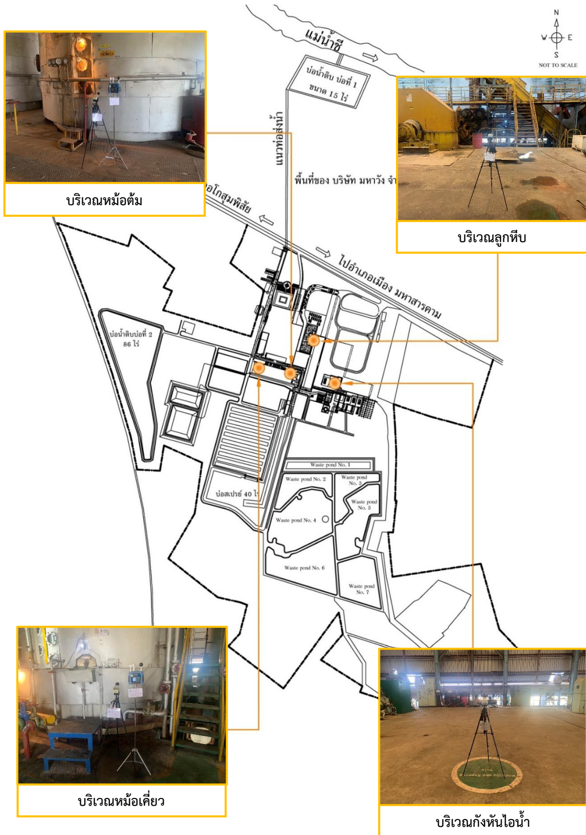
รูปที่ 3.6-1 ตำแหน่งและภาพการตรวจวัดระดับเสียงในสถานประกอบการ
